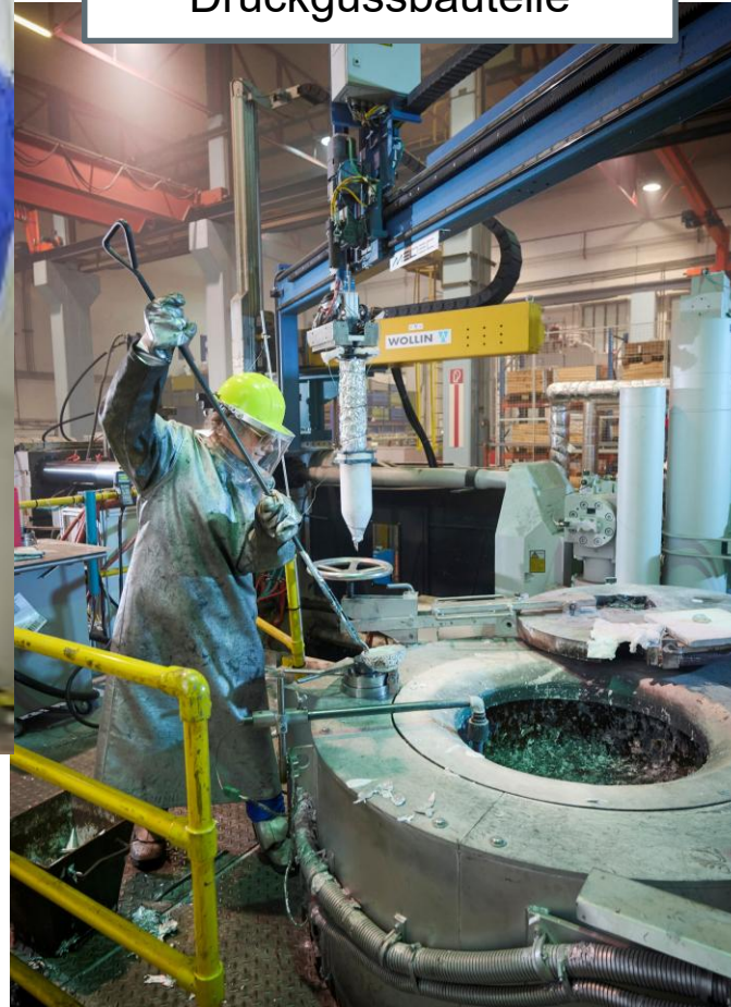
Semi-Solid-Dosier-Einheit für hochqualitative Druckgussbauteile
