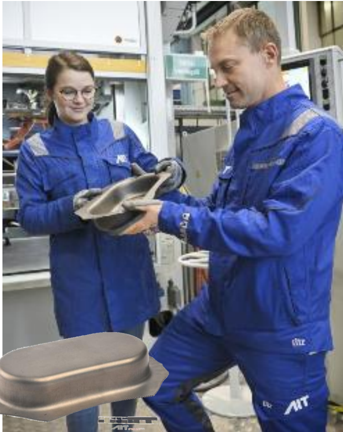
Neuartiges Titantiefziehverfahren (Ti6Al4V) bei niedrigen Umformtemperaturen
