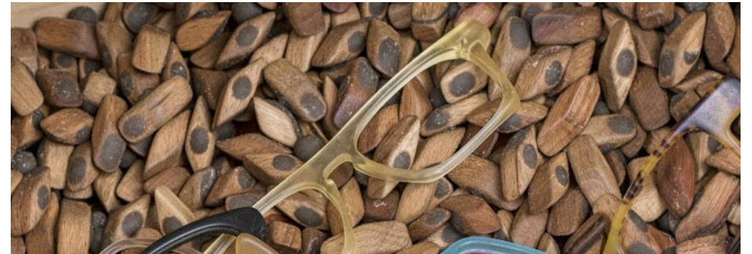
Schleifkörper Holz und abrasive Paste
