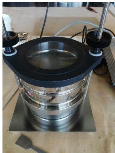
Fraktionierung mittels Ultraschallsieb
