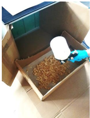
Binder aufgebracht auf Hobelspäne
