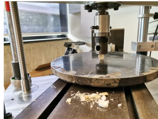
Druckfestigkeit getestet von Wood K plus Linz in Anlehnung an ÖNORM EN ISO 604.
