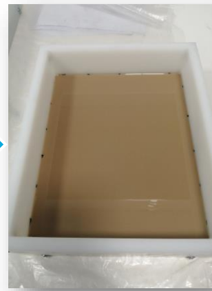
Steinmehlverbundplatte mit 67w% Steinmehl
